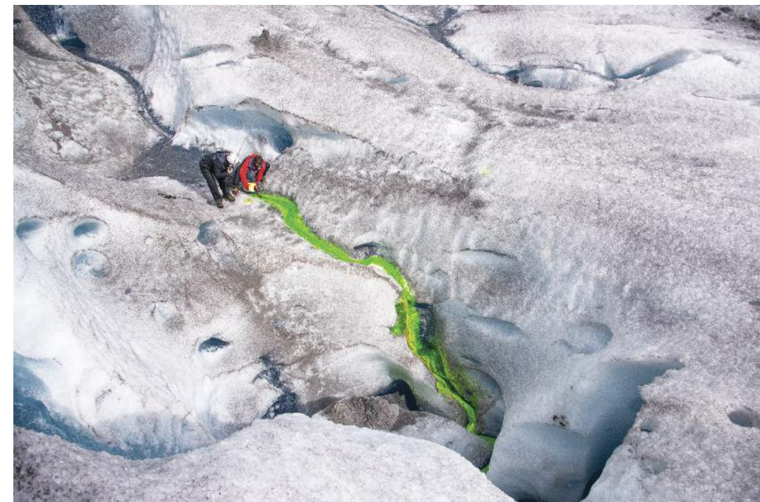
◀ Photo 4 : Expérience de coloration à la fluorescéine dans un moulin du glacier Témpanos, rive gauche, altitude 130 m.
